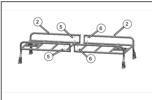
Installer les deux racks arrière (2) avec les vis (5) et les écrous (6). Ne les serrez pas complètement à ce stade.
