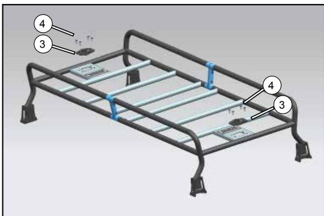
Installez les bases de serrage CF connect (3) sur la face arrière des racks avec les vis (4).
