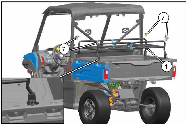
Comme indiqué sur l'image, positionnez le porte-bagages arrière (1) sur le lit arrière, puis installez les CF connecteurs les colliers (7), serrer les vis (5) et les écrous (6).
